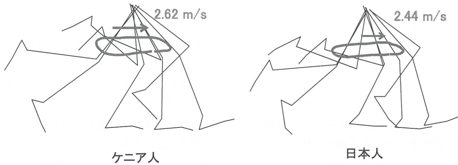
図6 ケニア人選手と日本人選手のスティックピクチャと脚全体の重心の軌跡
